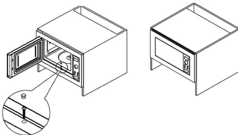
2. Откройте микроволновую печь, закрутите шуруп (3), затем установите пластиковый декоративный колпачок (2).
