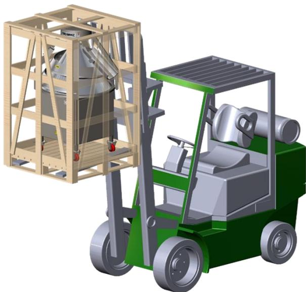
Рисунок 5 Перемещение вилочным погрузчиком
