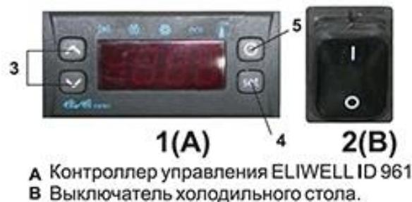
*Во время нормальной работы дисплей показывает текущую температуру рабочего пространства стола. В случае какого-либо сбоя экран полностью погаснет, либо индицируется ошибка с префиксом «Е».*
