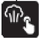
» - кнопка «**Ручной впрыск**» - при нажатии и удержании этой кнопки включается подача пара во всех режимах. подача пара происходит только при условии, что температура в камере не менее 150°C.
