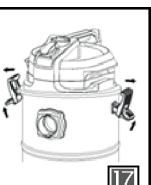
2) Возьмитесь одной рукой за ручку, а другой - за фильтр и поверните его против часовой стрелки, чтобы извлечь. (Рис.18)
