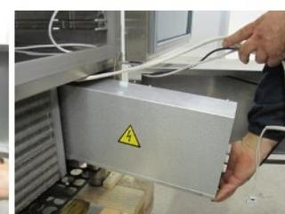
Снимите фиксирующий винт электрической панели.
