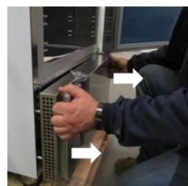
Снимите винты закрывающей панели.
