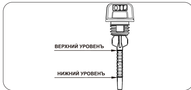
Рисунок 3. Отметки на масляном щупе.
