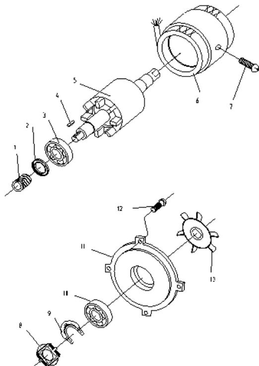
Рис. 4 – Деталировка. Электродвигатель
