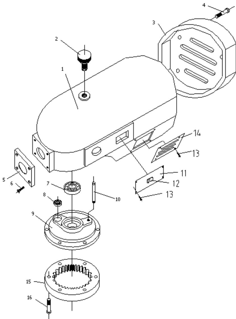
Рис. 2 – Детализовка. Головная часть миксера
