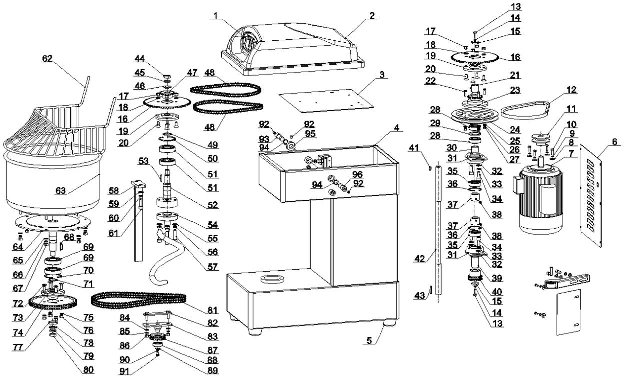
**НИЖЕ ПРИВЕДЕНА СХЕМА МЕХАНИЧЕСКОЙ ЧАСТИ HS-40С 2V
