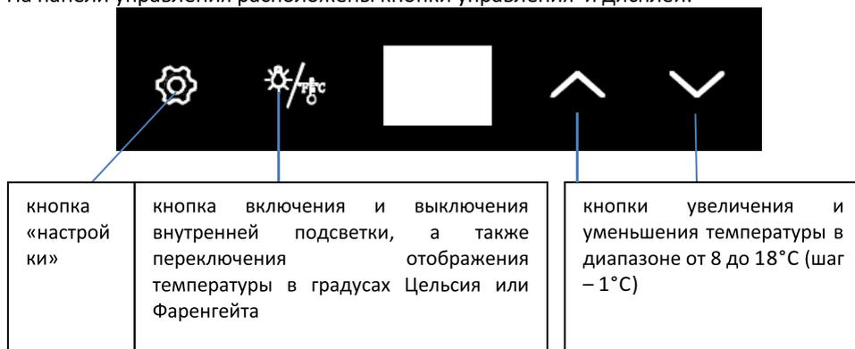
Панель управления автоматически блокируется по истечении 12 секунд после последнего действия на панели управления. Для разблокировки панели управления необходимо нажать и удерживать в течение 2-х секунд кнопку включения/выключения подсветки и переключения отображения температуры в градусах Цельсия или Фаренгейта. После разблокировки будет слышен короткий звуковой сигнал.
