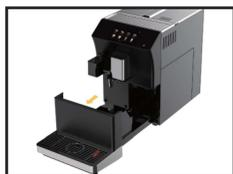
Когда ящик для кофейной гущи заполнен (12 порций), на экране появится соответствующее сообщение. Его необходимо опорожнить и очистить для продолжения приготовления напитков. Для извлечения ящика для кофейной гущи, вытащите сливной поддон для воды. Опорожните поддон и очистите его. С помощью щетки опорожните ящик для кофейной гущи и тщательно очистите его от остатков.
