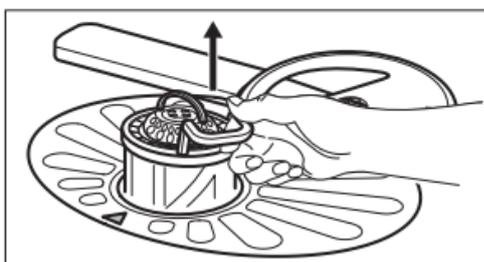
2. Снимите фильтр (C) с фильтра (B)
