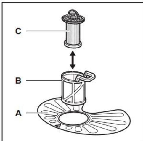
1. Поверните фильтр (B) против часовой стрелки и снимите его.
