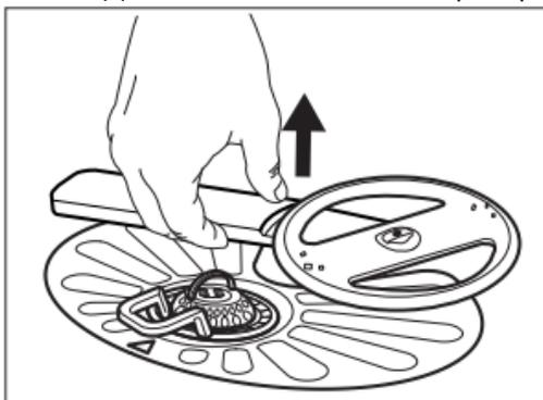
2. Промойте разбрызгиватель под струей воды. Для удаления частиц грязи из отверстий воспользуйтесь тонким острым предметом, например, зубочисткой
