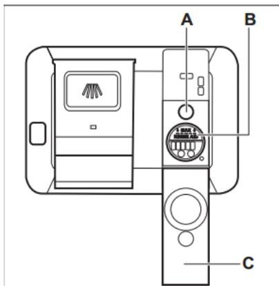
⚠ **ВНИМАНИЕ!** Отсек (В) предназначен только для дозирования ополаскивателя. Не заполняйте его моющим средством.
