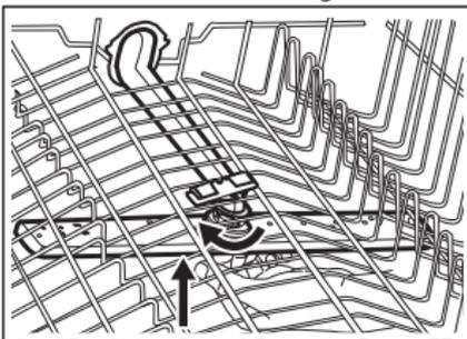
3. Промойте распылитель под проточной водой. Используйте острый предмет, например, зубочистку, чтобы удалить грязь
