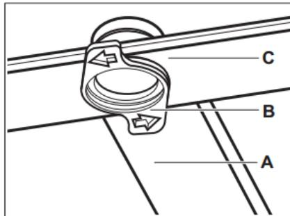
1. Освободите фиксаторы по бокам направляющих ящика для столовых приборов и выдвиньте ящик.
