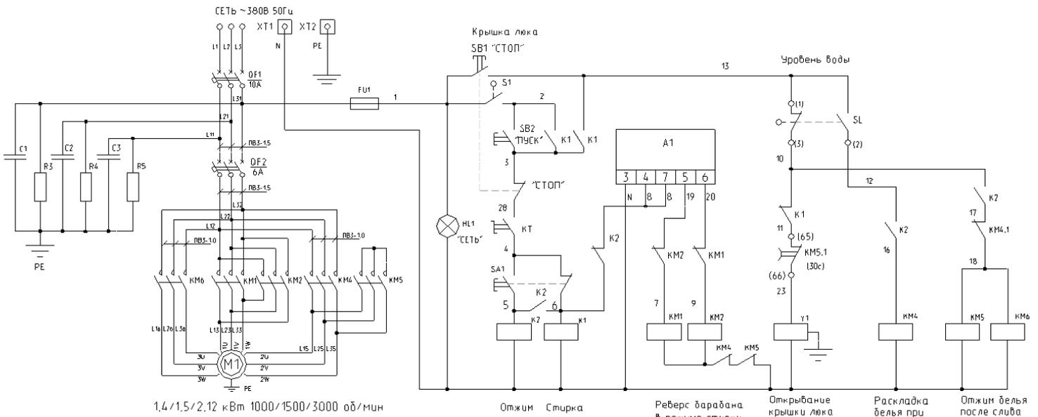
Рис.3б. Схема электрическая принципиальная машины стиральной Л30-211
