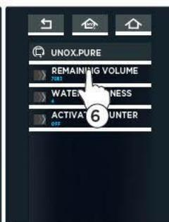
Den Parameter „Restliter“ auswählen: Auf dem Display wird angezeigt, wie viele Liter Wasser nach dem Filterwechsel noch vorhanden sind.
