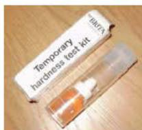
Die die Härte des Leitungswassers in deutschen Grad - °dH (z. B. durch Entnahme aus dem Wasserhahn) mit dem mitgelieferten Kit unter Beachtung der beiliegenden Anweisungen messen.
